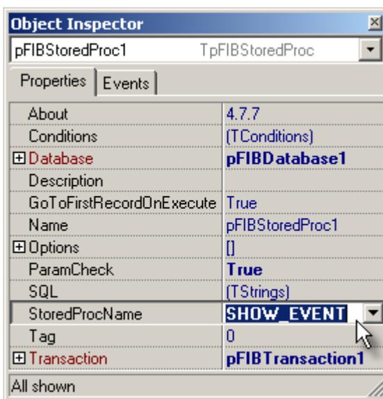
Рис. 2.72. Вызов хранимой процедуры при помощи компонента TpFIBStoredProc
