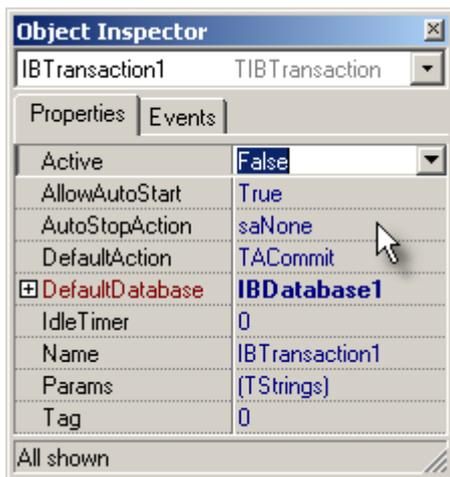
Рис. 2.4. Свойства TIBTransaction
