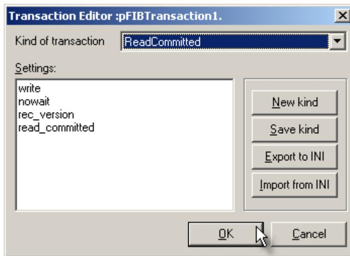
Рис. 2.16. Редактор компонента TrFIBTransaction
