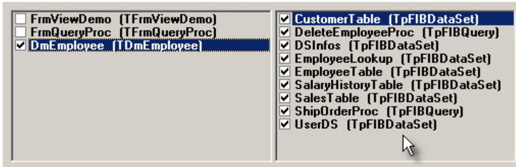
Рис. 2.55. Выделение группы компонентов при помощи SQL Navigator
